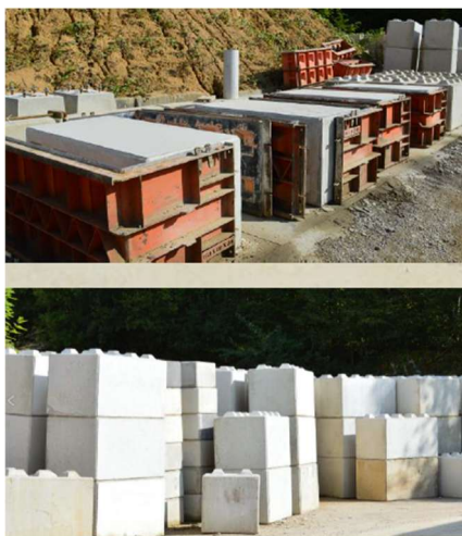
Production de maxi-blocs
