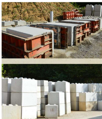
Production de maxi-blocs
